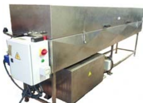
Máquina para cardanes de longitud hasta 2500mm y 150 kg de peso.
